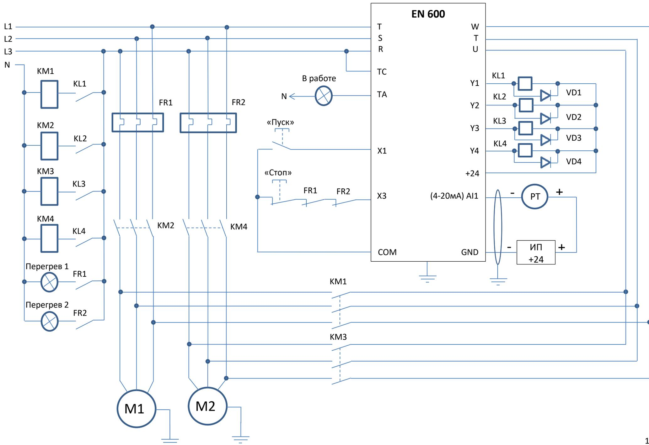
Преобразователи серии EN600 позволяют организовать каскад из двух одинаковых (с одинаковыми электродвигателями) насосов без дополнительного контроллера (верхнего уровня управления).
