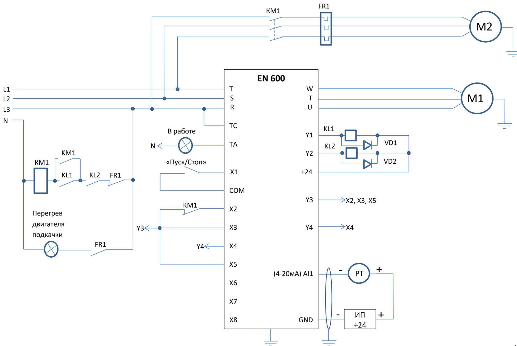
Данная схема подключения позволяет использовать в дополнение к основному насосу включенному с ПИД регулированием подключать насос подкачки меньшей производительности (до 70% от основного) при пиковом расходе воды из системы. В настройках предусмотрено снижение производительности основного насоса при подключении насоса подкачки для устранения возможности возникновения гидроудара в системе.
