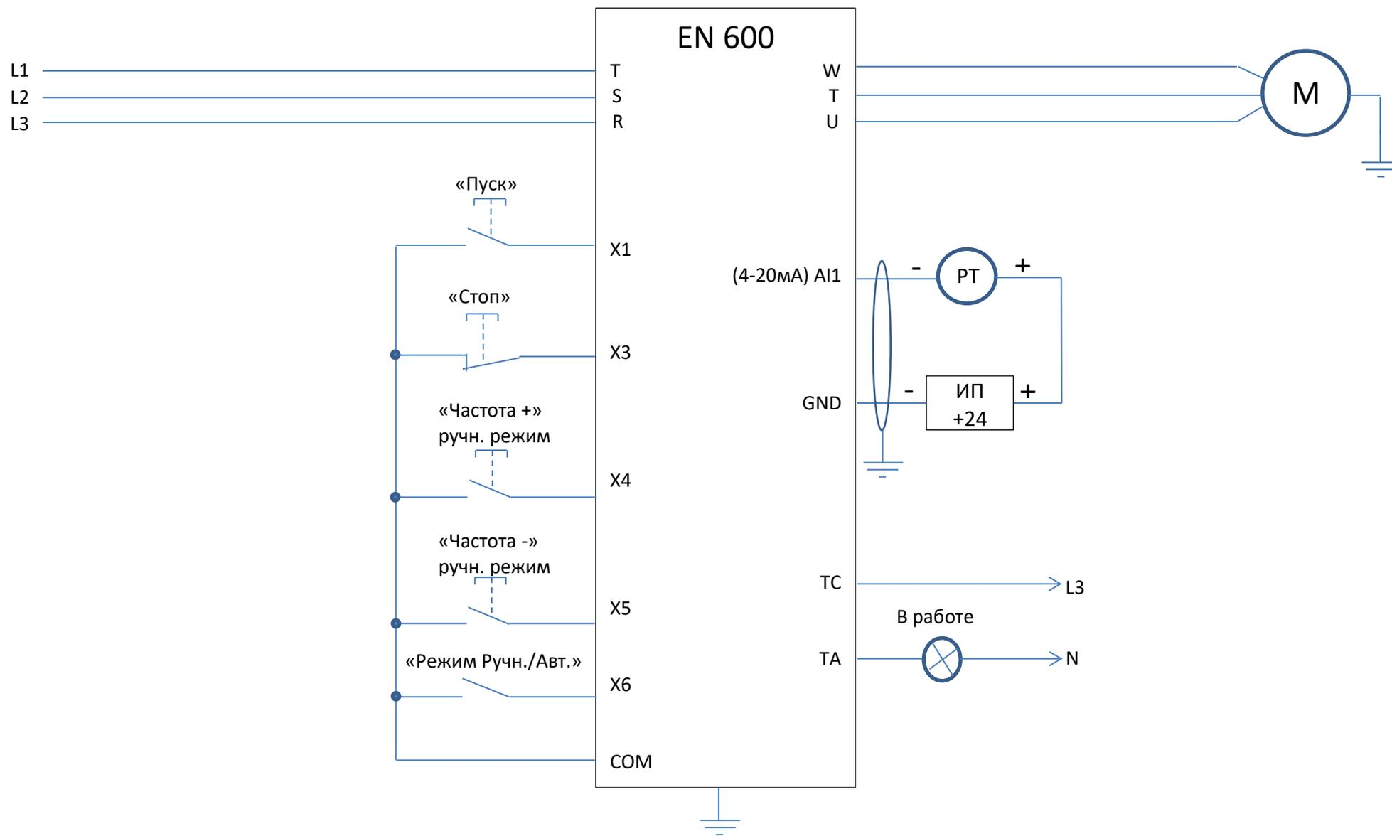
**Рекомендация:** Для контроля изменения давления при регулировке оборотов двигателя в ручном режиме установите пульт с двумя LED дисплеями.
